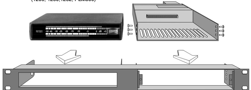
19"-3HE-Blende für ein Einbauminstrument 40 x 190 mm und ein Tischgerät
