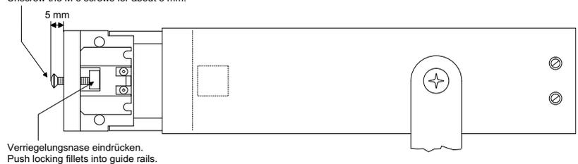
4) Schieben Sie das Instrument ins Gehäuse 1020E bzw. in die 19"/1HE-Blende (mit angeschraubter Anschlusseinheit 1128H) ein und ziehen Sie die Kreuzschlitzschrauben der Frontplatte an.
