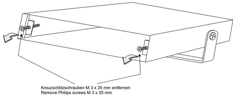
2) Drehen Sie am Instrument die beiden Kreuzschlitzschrauben ca. 5 mm aus der Frontplatte heraus.
