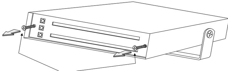
Kreuzschlitzschrauben M 3 x 35 mm entfernen
