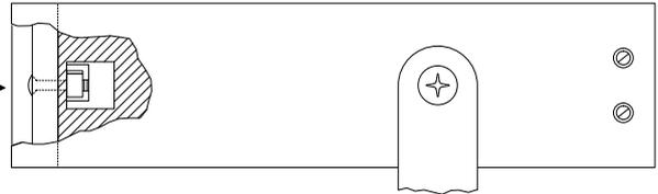
2) Drehen Sie diese Schrauben ca. 5 mm aus der Frontblende des Instrumentes heraus.
