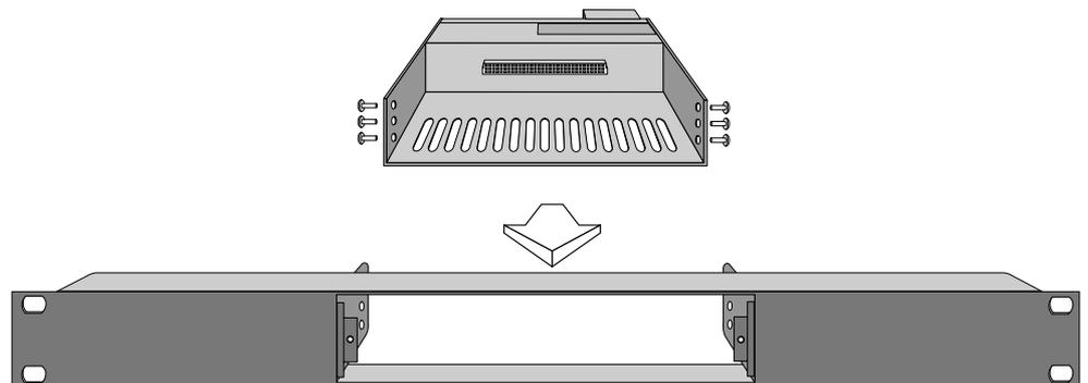
19"-3HE-Blende für ein Einbauminstrument 40 x 190 mm
