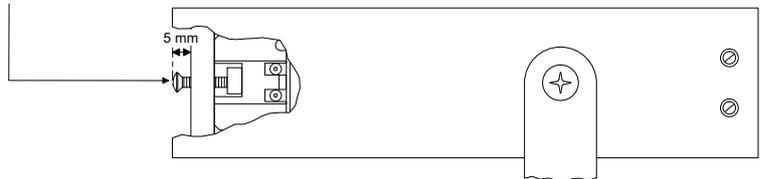
3) Benutzen Sie die Schraubenköpfe als Griff und ziehen Sie das Instrument aus dem Gehäuse 1020E bzw. aus der 19"/1HE-Blende (mit angeschraubter Anschlusseinheit 1128H) heraus.
