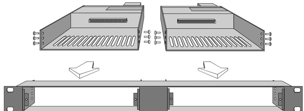
19"-3HE-Blende für zwei Einbauminstrumente 40 x 190 mm
