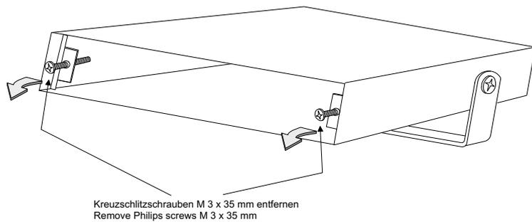
3) Schieben Sie das Instrument in das Gehäuse 1020E bzw. die 19"/1HE-Blende (mit angeschraubter Anschlusseinheit 1128H) ein und befestigen Sie es mit den Kreuzschlitzschrauben M 3 x 35 mm.
