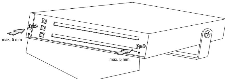
Kreuzschlitzschrauben B 3,5 x 19 mm spanlos, selbstschneidend max. 5 mm eindrehen.
