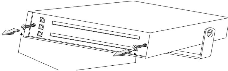
Kreuzschlitzschrauben M 3 x 35 mm entfernen
