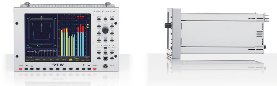
SurroundControl 31960 Serie Halb-19“-Einschub mit 6,5“-VGA-TFT-Display und Bedienfeldern
