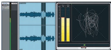
Abbildung 5: Pegelmessung und Vektorskop in der DAW
