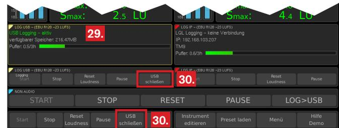
30. Berühren Sie die jetzt mit **USB schließen** beschriftete Taste, um die Erfassung der Logging-Daten zu beenden, zu speichern und die Log-Datei zu schließen. Während dieses Vorgangs wird in der obersten Zeile des Logging-Instruments die Meldung „USB Logging – beschäftigt“ (rot) angezeigt.
