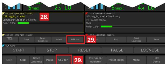
29. Berühren Sie die mit **USB starten** beschriftete Taste, um die Erfassung der Logging-Daten für die Speicherung in eine Log-Datei auf dem angeschlossenen USB-Stick zu starten. In der obersten Zeile des Logging-Instrument wird während dieses Vorgangs die Meldung „USB Logging – aktiv“ (grün) angezeigt.
