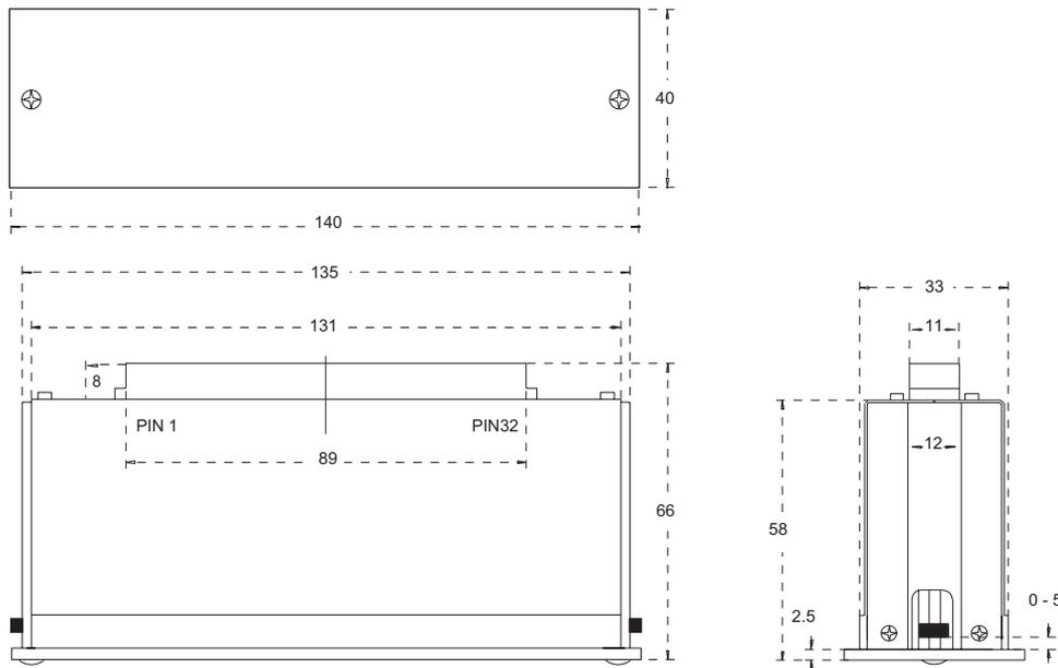
Abmessungen in Millimeter: Darstellung reduziert.
