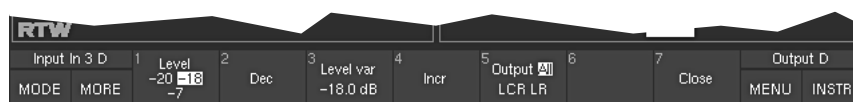
Bild 3-20: Bildschirmanzeige der 1. Funktionsebene im Instrument LF-TEST. Weitere Funktionen (2. Ebene) sind über die Taste „MORE“ erreichbar.
