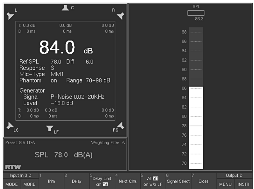
Bild 3-16: Bildschirmanzeige der 1. Funktionsebene im Instrument CAL. Weitere Funktionen (2. Ebene) sind über die Taste „MORE“ erreichbar.
