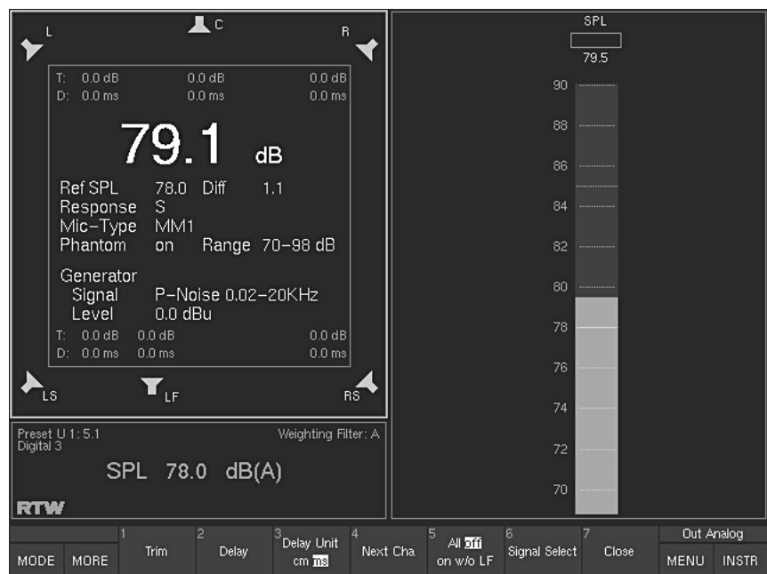
Bild 5-33: Bildschirmanzeige der 1. Funktionsebene im „CAL“-Instrument. Weitere Funktionen (2. Ebene) sind über die Taste „MORE“ erreichbar.
