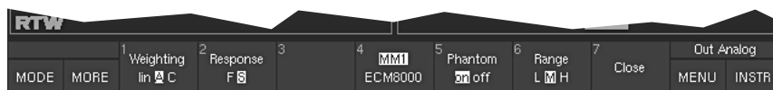
Bild 5-41: Anzeige nach Aufruf der Funktion „SPL Meter“ (in der zweiten Funktionsebene des „CAL“-Instruments)
