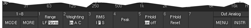
Bild 5-25: Zweite Funktionsebene der „RTA“-Instrumente im Mehrkanal-Modus nach Betätigen der Taste „MORE“ (Beispiel: „RTA 1/6“)
