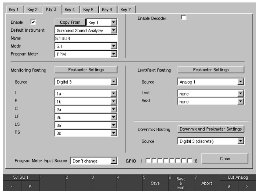
Bild 3-12: Die „Key 1“- bis „Key 7“-Menü-Karteikarten für die Sub-Presets im „Monitoring Input Routing“
